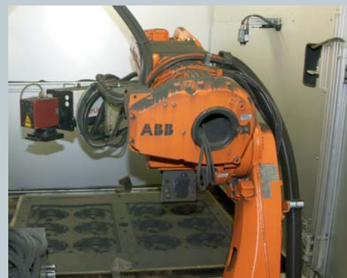
Laser-Roboter-System erreicht nahezu jeden Punkt im Formkasten.
