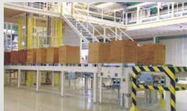
Mittels akkumulierenden Rollenförderer werden die Paletten gemäß Anforderung hintereinander aufgereiht und in dieser Folge der Produktion zur Verfügung gestellt
