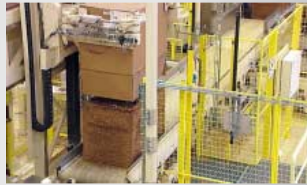
Der speziell entwickelte Portalgreifer zieht den Teleskopkarton vom Tabakballen ab.
