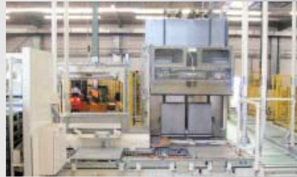
Der reine Tabakballen wird dem Divider zugeführt und exakt senkrecht im Verhältnis 50:50 geteilt.
