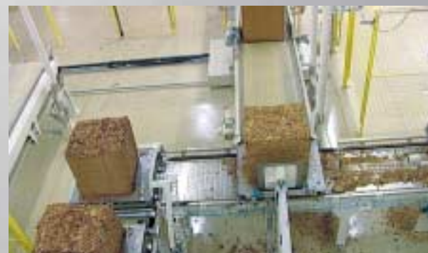
Zwei pneumatische Pushersysteme schieben den Tabakballen von der Sonderpalette
