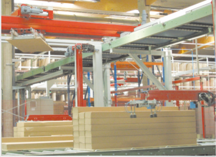
Automatische Kommissionierung für Türen und/oder Zargen mittels Portalroboter.
