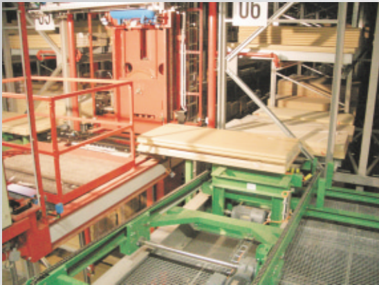
RBG übergibt einen Türstapel palettenlos auf die Fördertechnik.
