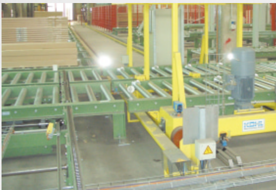
Schneller Fahrwagen zur Aufnahme von 2 Stapel.
