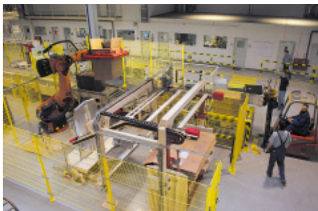
Die Entleerungsanlage besteht aus einem Fünfachsen-Roboter, einem Kartonfalt-system und einer Kartonstapelvorrichtung. Leistung pro Stunde: 75 x C48-Kartons
