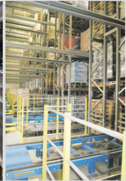
Hightech-Hochregallager mit 8700 Palettenplätze und 7 Gassen mit RBG's
