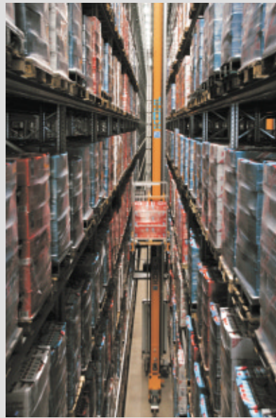
Hightech-Hochregallager mit 8700 Palettenplätze und 7 Gassen mit RBG's
