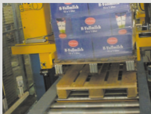
Zwei Düsseldorf-Paletten werden nach dem Verpacken wieder auf eine EURO-Palette "gesattelt".
