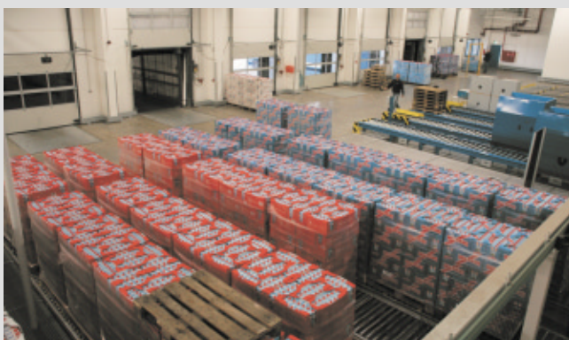
Tourenbereitstellung der einzelnen Kommissionen, ausgebildet als Fließlager mit Vereinzelungsmechanik am jeweiligen Bahnende
